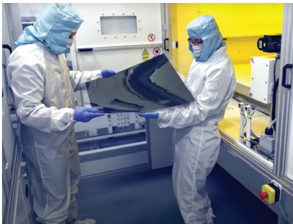
„Saule Technologies“ sukurti lankstūs perovskitiniai saulės elementai (nuotr. iš „Saule Technologies“ interneto svetainės)
